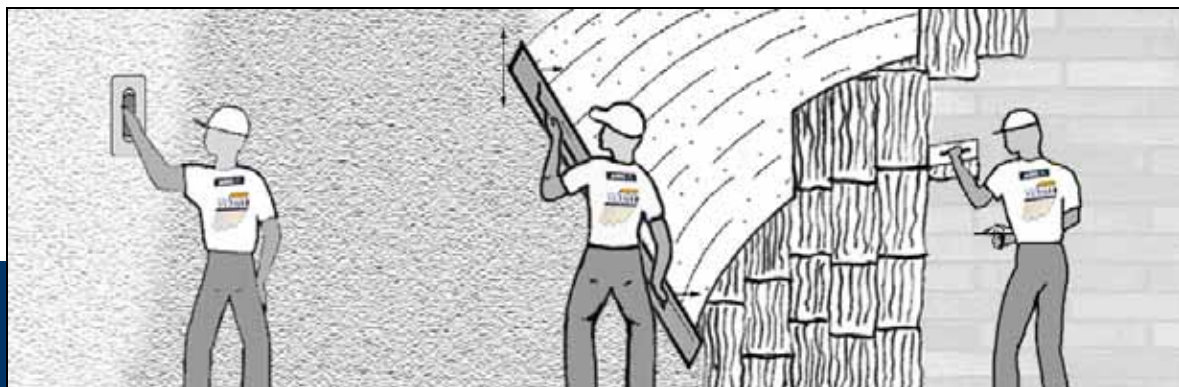
(diagram.6) maintaining a wet edge
